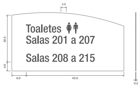
Chapa metálica vistas ortográficas da frente
